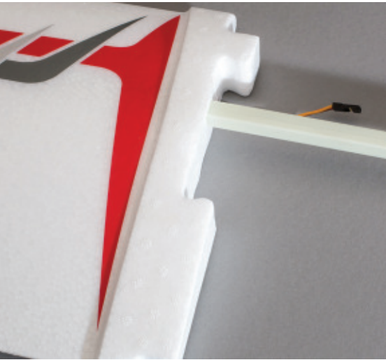
Der Vierkant-GFK-Stab ließ sich anfangs sehr schwergängig in die Flächenhälften schieben. Er sorgt aber für eine erhöhte Torsionssteifigkeit.
