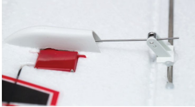
Um den Querrudern in der Landstellung mehr Ausschlag zu geben, kann man das Gestänge am Ruderhorn weiter innen einhängen.
