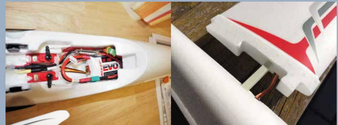
Der Lipo mit BID System passt perfekt in den Rumpf. Der neue Vierkant-GFK Stab verbindet die beiden Flügel.
