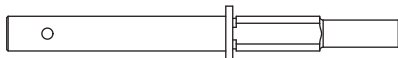
AX31539 (x1) Slipper drive gear shaft Gleittriebswelle Arbre d'engrenage d'entraînement du sabot Albero trasmissione pattino
