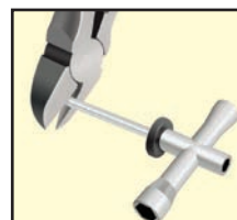
Installation/enlèvement du piston
